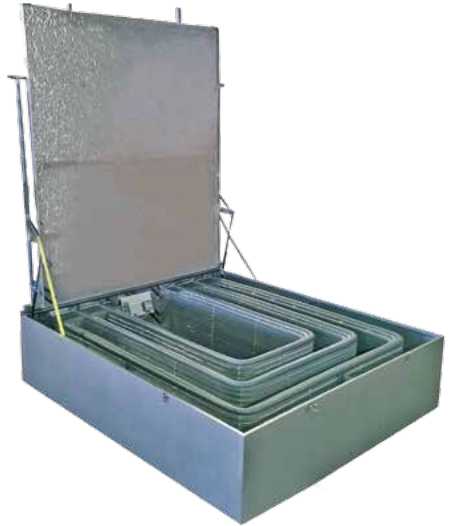
Kolmilohkoinen ilmanottokatos varustettuna neulälämmönsiirtimillä, jotka huolehtivat sekä lämmöntalteenotosta että tuloilman passiivilämmityksestä ja -jäähtymisestä (ilmavirta 1,7 m 3 /s)
