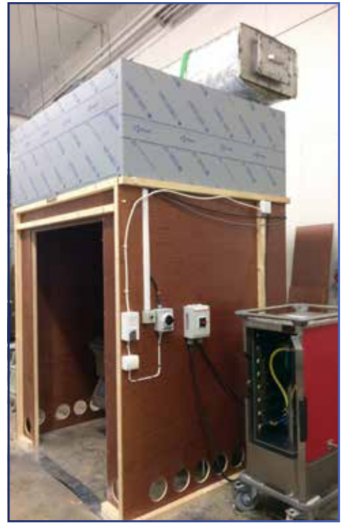
KUVA 5 | Koehuone ja aerosoligeneraattori.
